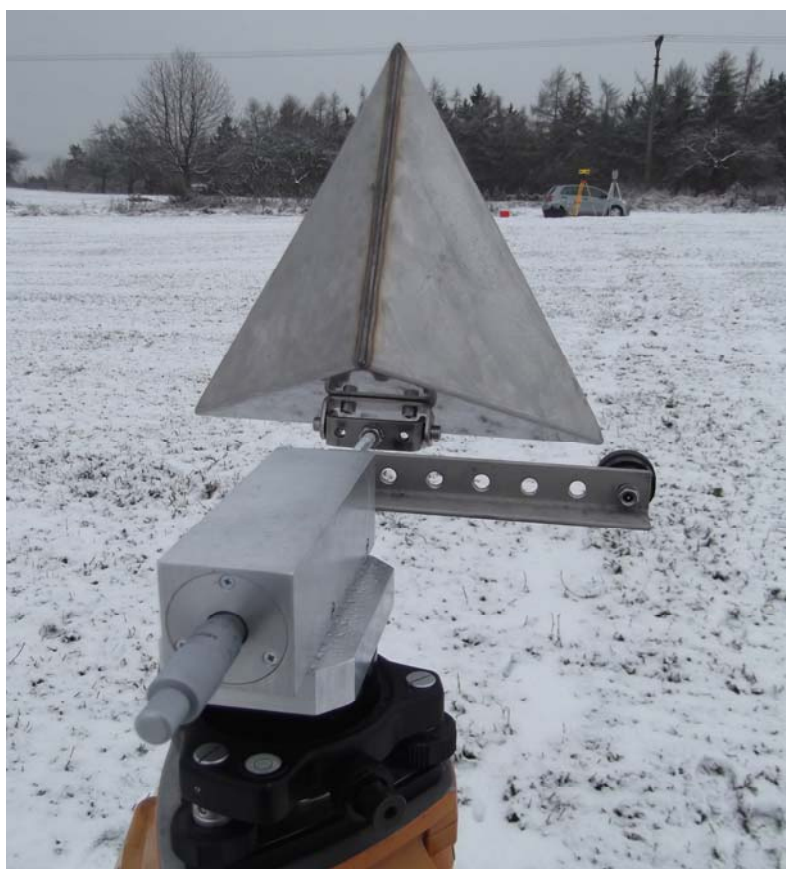
Obr. 1: Mikrometrické zařízení opatřené koutovým odražečem
