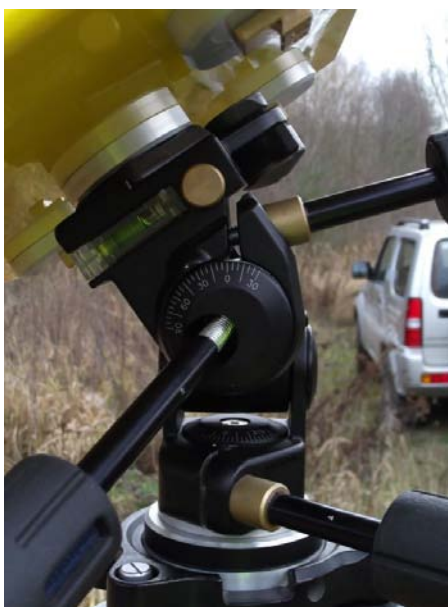
Obr. 4: Odečtení výškového náklonu radaru na stupnici 3D hlavy stativu
